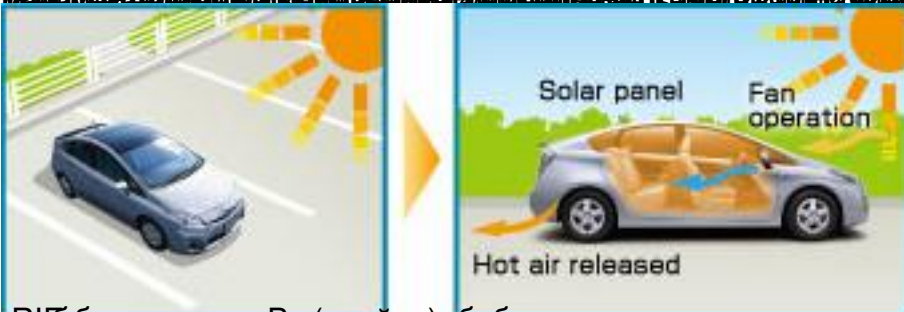
Система Solar Panel (SP) и функция Fan operation (FO) снижают температуру в салоне автомобиля
